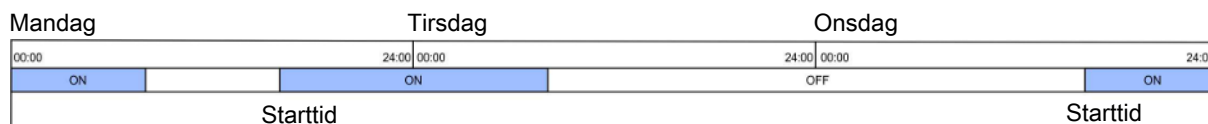
Figur 5: Hvis en ON-tid løber over midnat på et døgn, hvor uret ikke er aktivt, vil funktionen forblive ON, indtil tiden er udløbet.
